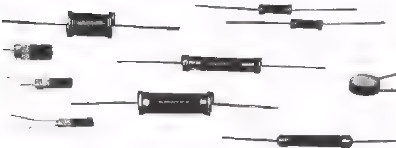
Staafvormige NTC-weerstanden voor gebruik in radio- en TV-ontvangers.
